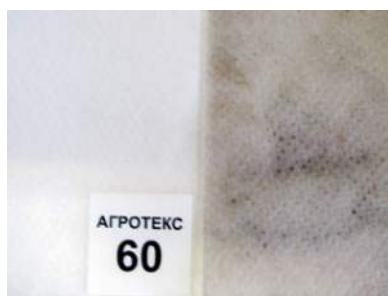
Рисунок 2. Внешний вид белого материала «Спанбонд» плотностью 60 г/м 2 при различной степени загрязнения в процессе четырехлетней эксплуатации на маточной плантации земляники опытного участка ФГБНУ ФНЦ имени Мичурина с черноземным типом почвы.
