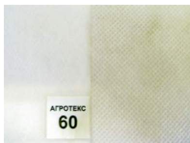
Рисунок 2. Внешний вид белого материала «Спанбонд» плотностью 60 г/м 2 при различной степени загрязнения в процессе четырехлетней эксплуатации на маточной плантации земляники опытного участка ФГБНУ ФНЦ имени Мичурина с черноземным типом почвы.
