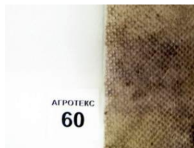
Рисунок 2. Внешний вид белого материала «Спанбонд» плотностью 60 г/м 2 при различной степени загрязнения в процессе четырехлетней эксплуатации на маточной плантации земляники опытного участка ФГБНУ ФНЦ имени Мичурина с черноземным типом почвы.
